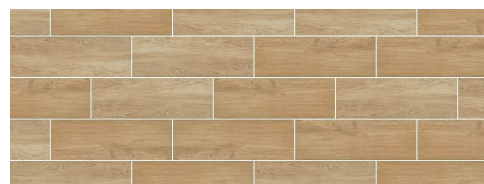
Sposób ułożenia płytek
